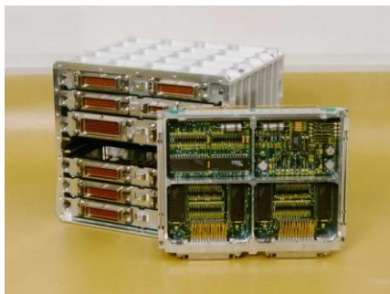
RTU (Unidade Terminal Remota)
